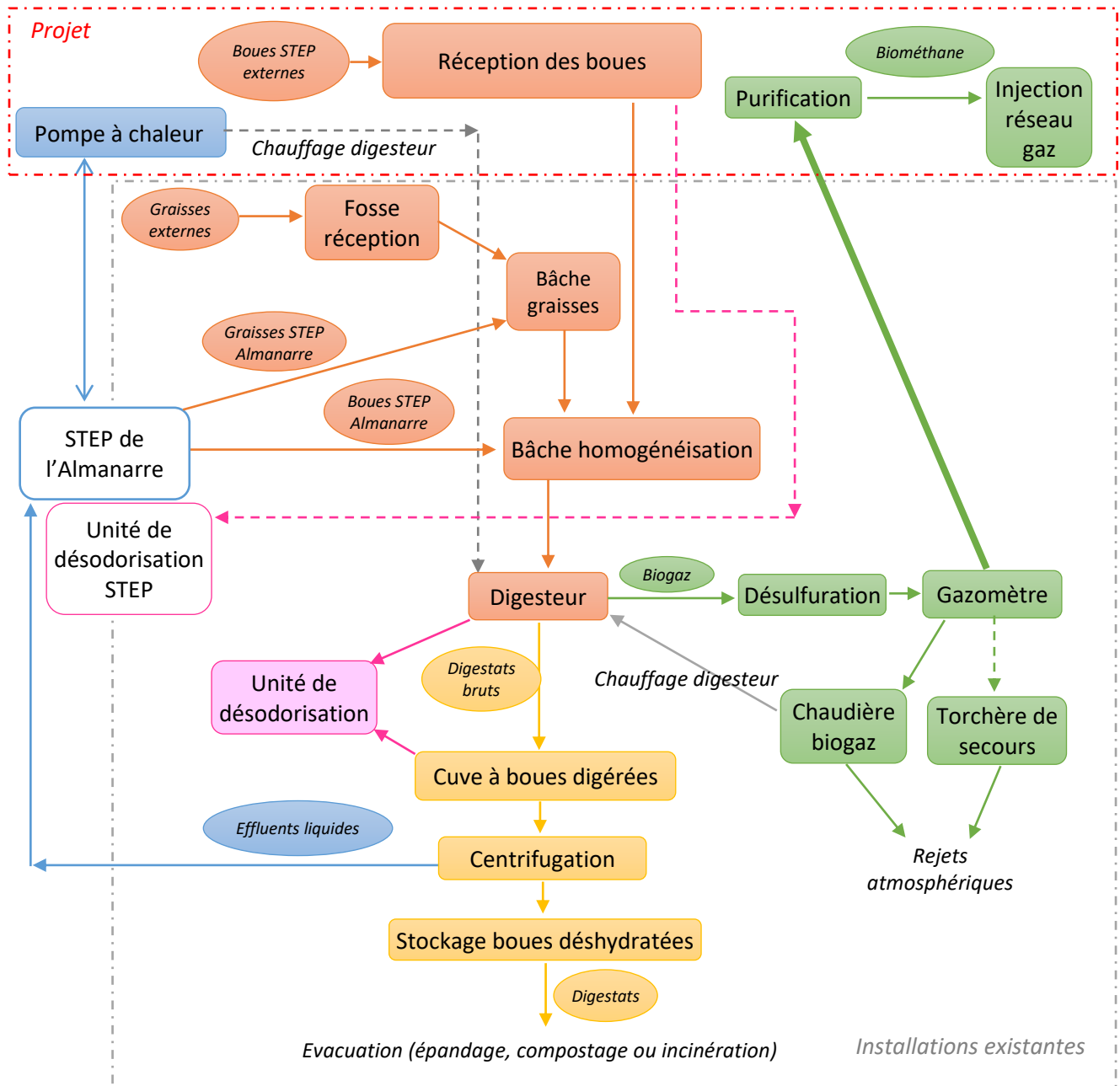
Figure 20 : Fonctionnement projeté de l'unité de méthanisation
